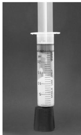
図 b 注射器内に気体が発生している様子
